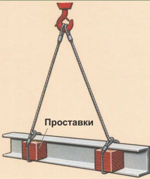
Швеллер. Два универсальных петлевых стропов - в обхват
