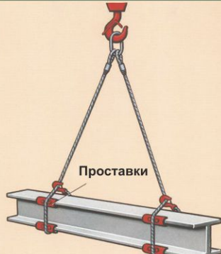
Двутавровая балка. Двухветвевой строп - в обхват
