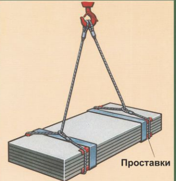
Пакет листов горизонтально. Два универсальных петлевых стропов - в обхват
